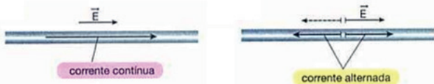
Esquema das correntes contínuas e alternadas. Fonte: ALVARENGA, Beatriz. Física. São Paulo: Scipione, 1998.
