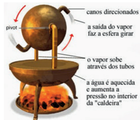
Esquema da eolípila de Heron. Fonte: http://eolipila.blogspot.com/2012/09/funcionamento-da-maquina-de-heron.html
