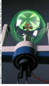
Figura 3. O físico britânico J.J. Thomson descobriu os elétrons em um experimento com um tubo de Crookes.
